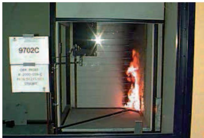
SBI - essai de réaction au feu
