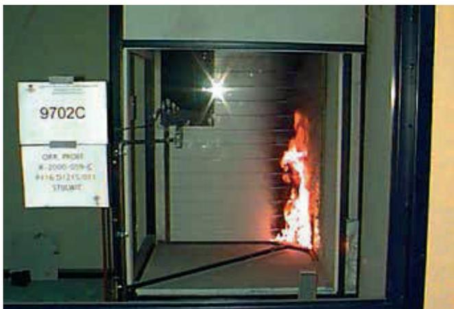
SBI - essai de réaction au feu
