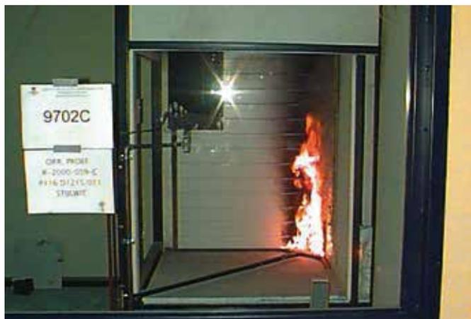
SBI - essai de réaction au feu
